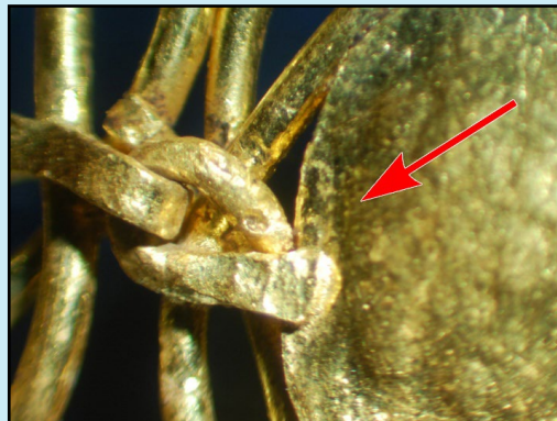
Fig. 3 Particolare di un gancio-occhiello saldato alla base del castone ovale e residuo di un paglione rettangolare di saldatura.
