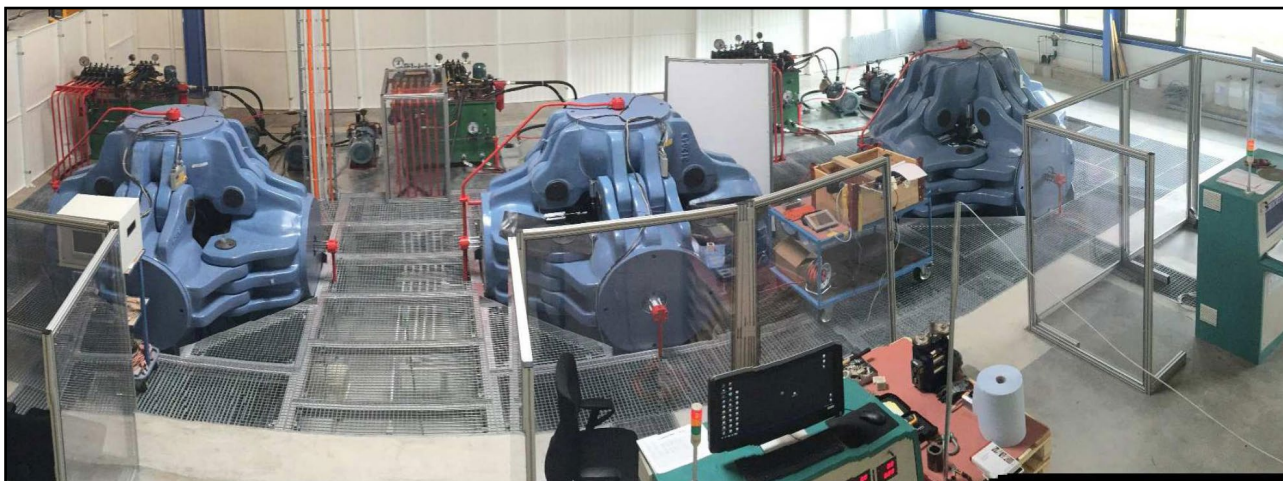
Fig. 2 Presse cubiche HPHT presso gli impianti di Reishauer in Svizzera dove attualmente oltre a qualche cristallo singolo sperimentale più grande si produce polvere di diamante sintetico usata come abrasivo nelle proprie strutture. Foto: T. Hainschwang.
