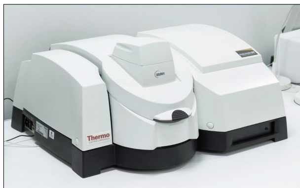
Fig. 1 Moderno spettrofotometro UV-Vis-NIR. Si noti l'ampio comparto di dimensioni standardizzate disegnato per accogliere i più diversi setup di campionamento.
