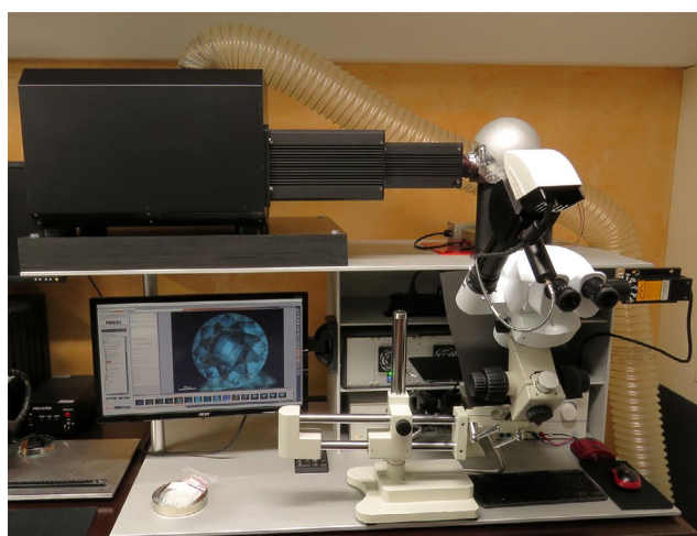
Fig. 7 L'unità GGTL DFI Deep UV Laser + Luminescence Microscope and Spectroscopy System (sinistra) e la reazione di un diamante naturale quasi incolore tipo la osservato mediante questo sistema (destra). Foto: T. Hainschwang.
