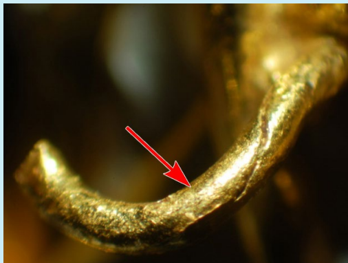
Fig. 8 Particolare delle linee elicoidali del filo d'oro ritorto che compone una delle due griffe che sosteneva la gemma mancante.
