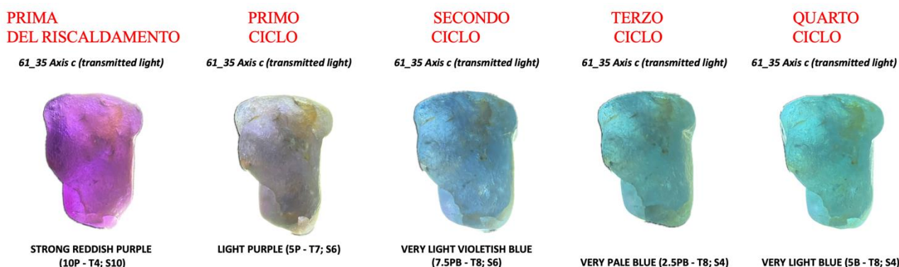
Figura 1: Trattamento termico di una tormalina cuprifera viola in ambiente riducente, con temperature crescenti ad ogni ciclo di riscaldamento, fino a raggiungimento del colore desiderato.
